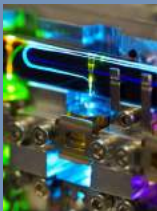
Photonische integrierte Schaltung (PIC) für biowissenschaftliche Anwendungen im sichtbaren Bereich. Quelle: TOPTICA Photonics AG
