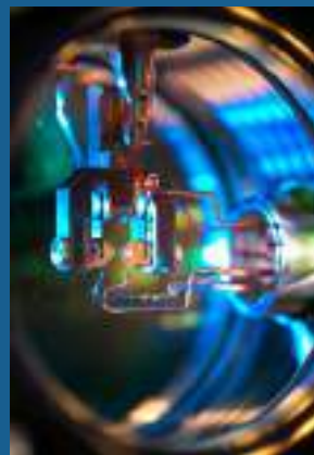
Ionenfalle für eine Atomuhr höchster Genauigkeit, die mit einem Laser ausgelesen wird. Quelle: Physikalisch-Technische Bundesanstalt
